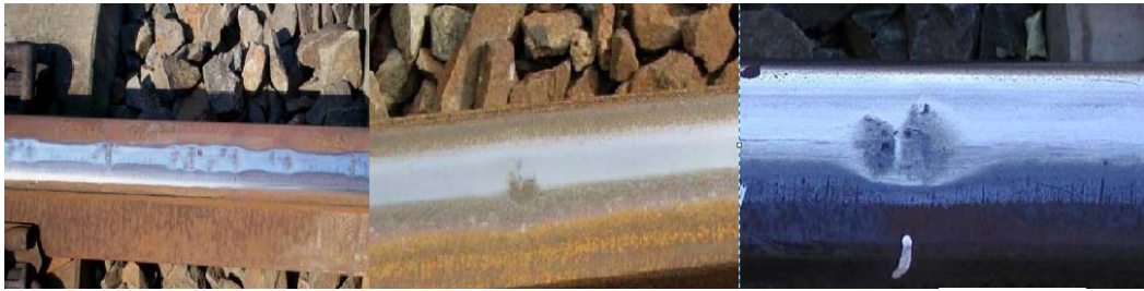
Şekil 8: Yuvarlanma Yüzeyinde Oluşan Lokal Çöküntüler
