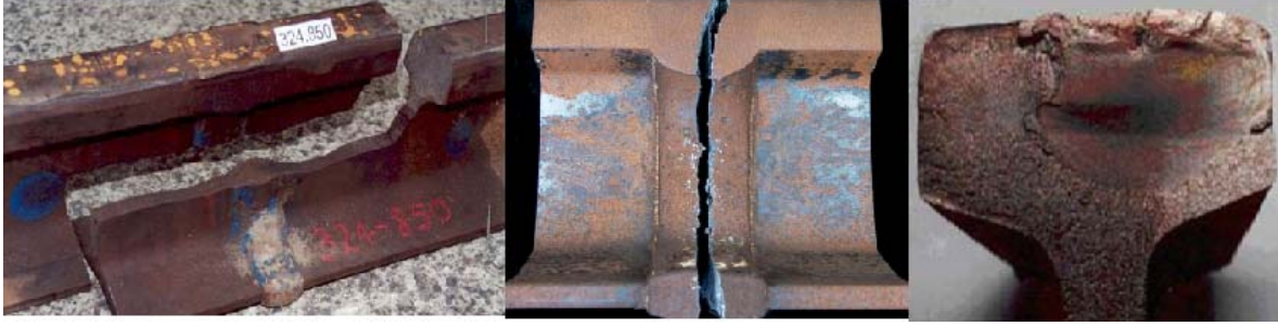
Şekil 14: Termit Kaynak ve Dolgu Kaynak Kusurları
