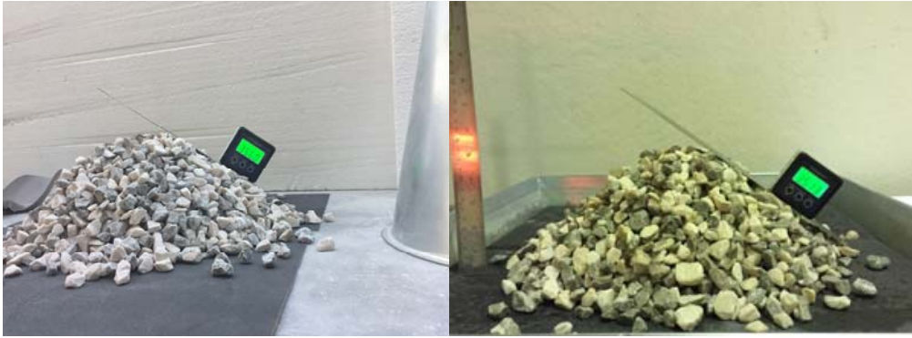
Şekil 2. Kireçtaşı 10 – 14 mm pürüzlü zeminde şişlenmemiş (sol sütun), şişlenmiş (sağ sütun) haldeki duruş açısı
